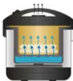
YUGTO NG PAGPAPASINGAW humihawalay ang gawgaw at nagaganap ang panghuling pagluluto ng bigas sa pamamagitan ng pagpapasingaw
