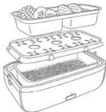
Coloque la bandeja de vapor sobre el arroz. Coloque el recipiente de comida encima de la bandeja de vapor del vassoio del vapore
