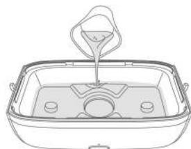
Usando el vaso medidor de 100 ml suministrado, vierta agua en la base de la unidad.
