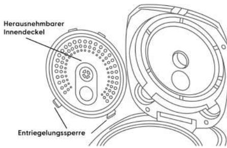
Der innere Deckel dieses Geräts ist abnehmbar. Ziehen Sie die Schlösser unten rechts und links vom Deckel und nehmen Sie ihn aus der Halterung. Waschen Sie den abnehmbaren Deckel nach jedem Garzyklus mit einem Schwamm in Seifenwasser.
