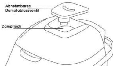
Die Dampfkappe oben auf dem Deckel ist abnehmbar - zum Entfernen nach oben ziehen. Waschen Sie dies regelmäßig.
